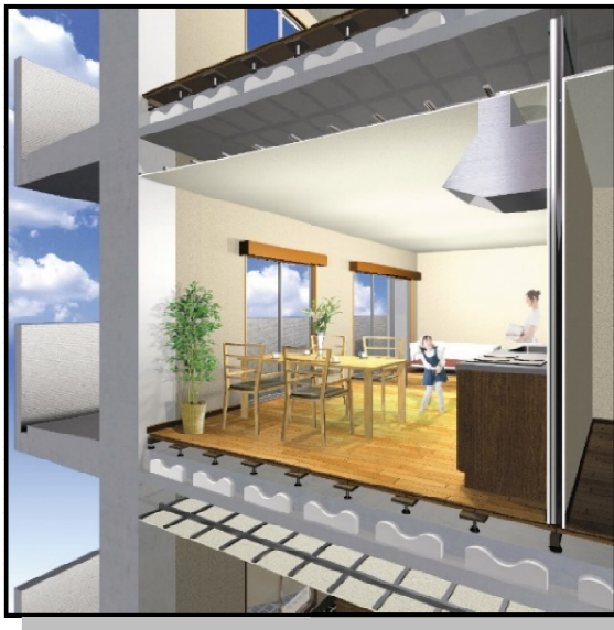
FL ボイドスラブ (材工)
