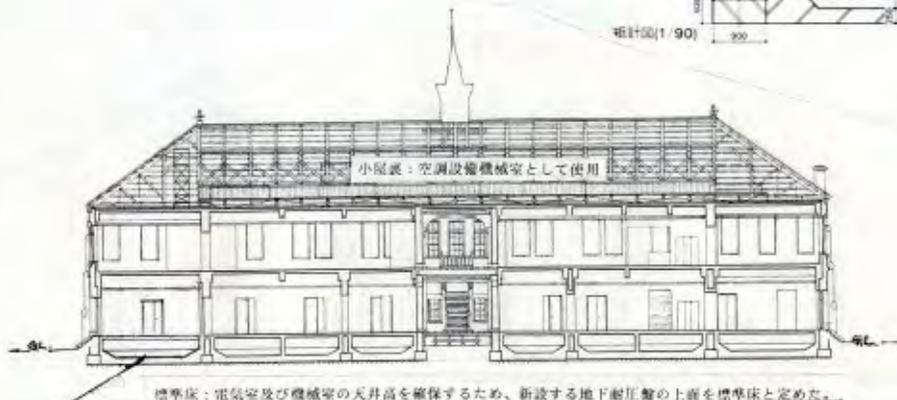
標準床：電気室及び機械室の天井高を確保するため、新設する地下圧力管の上を標準床と定めた。
