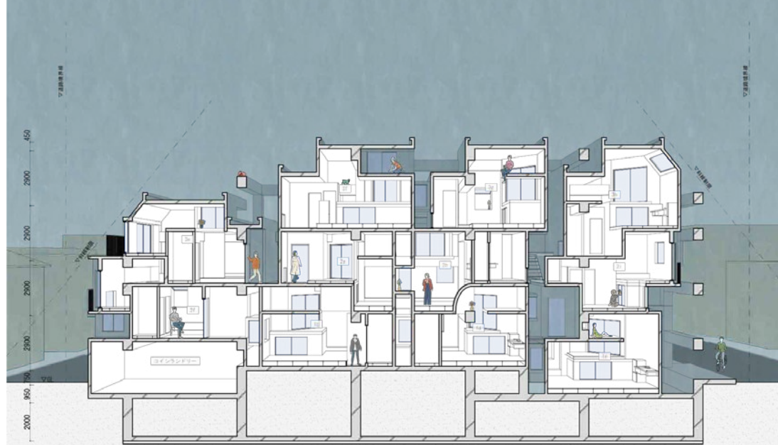
01 | ボリュームを周辺から距離をと りながら配置する。 02 | 共用廊下を敷地中央に設けるた めに、南北で分棟にする。 03 | 周辺の住戸間隔でスリットを設 け、敷地内部の採光、通風を図る 04 | 斜線制限を考慮してボリューム を削り、一部半地下にする。 05 | 住戸間隔に合わせて構造フ レームを配置する。
