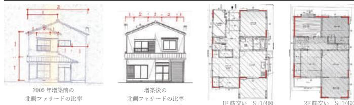
既存佐藤家では木造在来軸組工法であることから910mmの壁が主に外周部でとられるため隅から910mmは開口がなく、壁面中央に1820mmの開口が多い。
