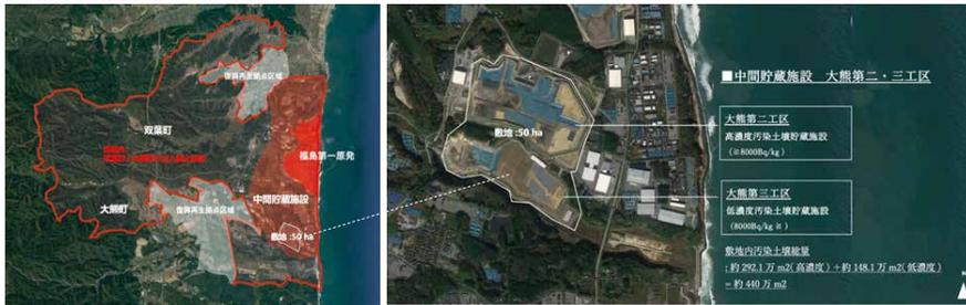
敷地は、現在立ち入り禁止の中間貯蔵施設（汚染土壌の貯蔵施設）の一部分である。敷地には約440万m<sup>2</sup>の汚染土壌が保管されている。高濃度と低濃度の汚染土壌それぞれを貯蔵する2つの土壌汚染貯蔵施設で構成される。
