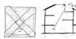
最上部にバルコニーとなる屋根のない部屋を計画し、プライバシーを確保した屋外空間を設けた。間仕切りがないことより、この部分から住宅内部の奥深くまで光が差し込み、吹き抜けを介して室内全体を明るく照らす。
